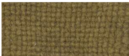
NCS S 5030-Y | 1705 Pichi Romero | Hojas + Ramas | Santa Bárbara, R. del Biobío | Verano | S. cobre | Sin amoniaco
