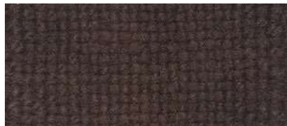
NCS S 8010-Y70R | 1702 Pichi Romero | Hojas + Ramas | Santa Bárbara, R. del Biobío | Verano | S. hierro | Sin amoníaco
